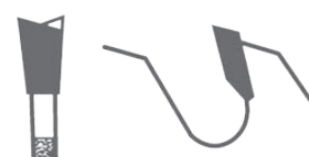
Dientes ATB bisel superior alterno
