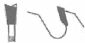
Dientes ATB bisel superior alterno
